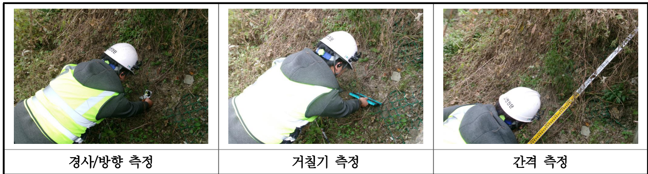
【사진 19.3.2】 불연속면 측정 현황
